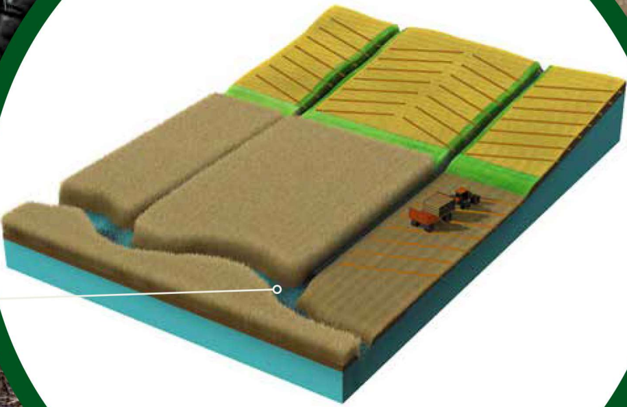
Канавы с заграждениями обеспечивают высокий и стабильный уровень воды
