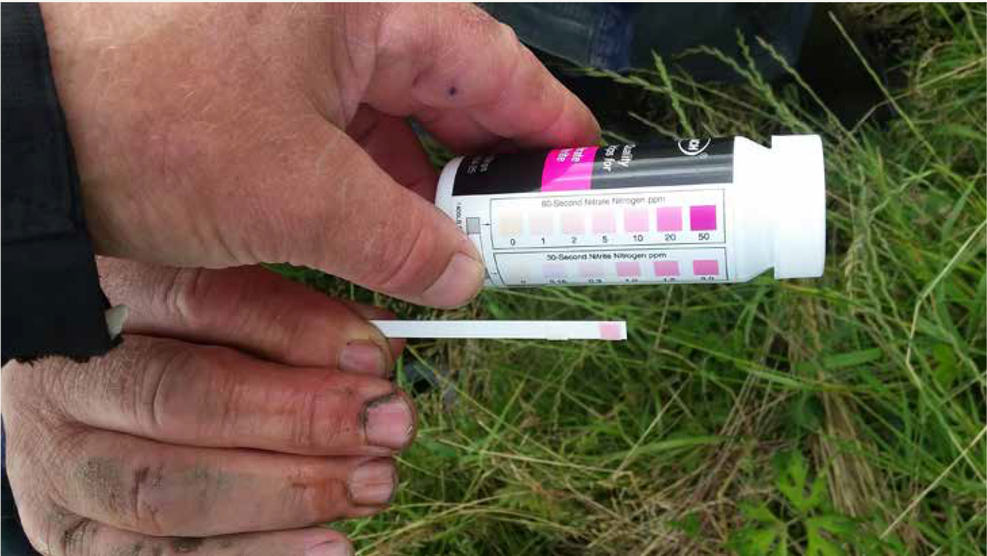
Тест-полоски удобны для определения уровня концентрации нитратов.
