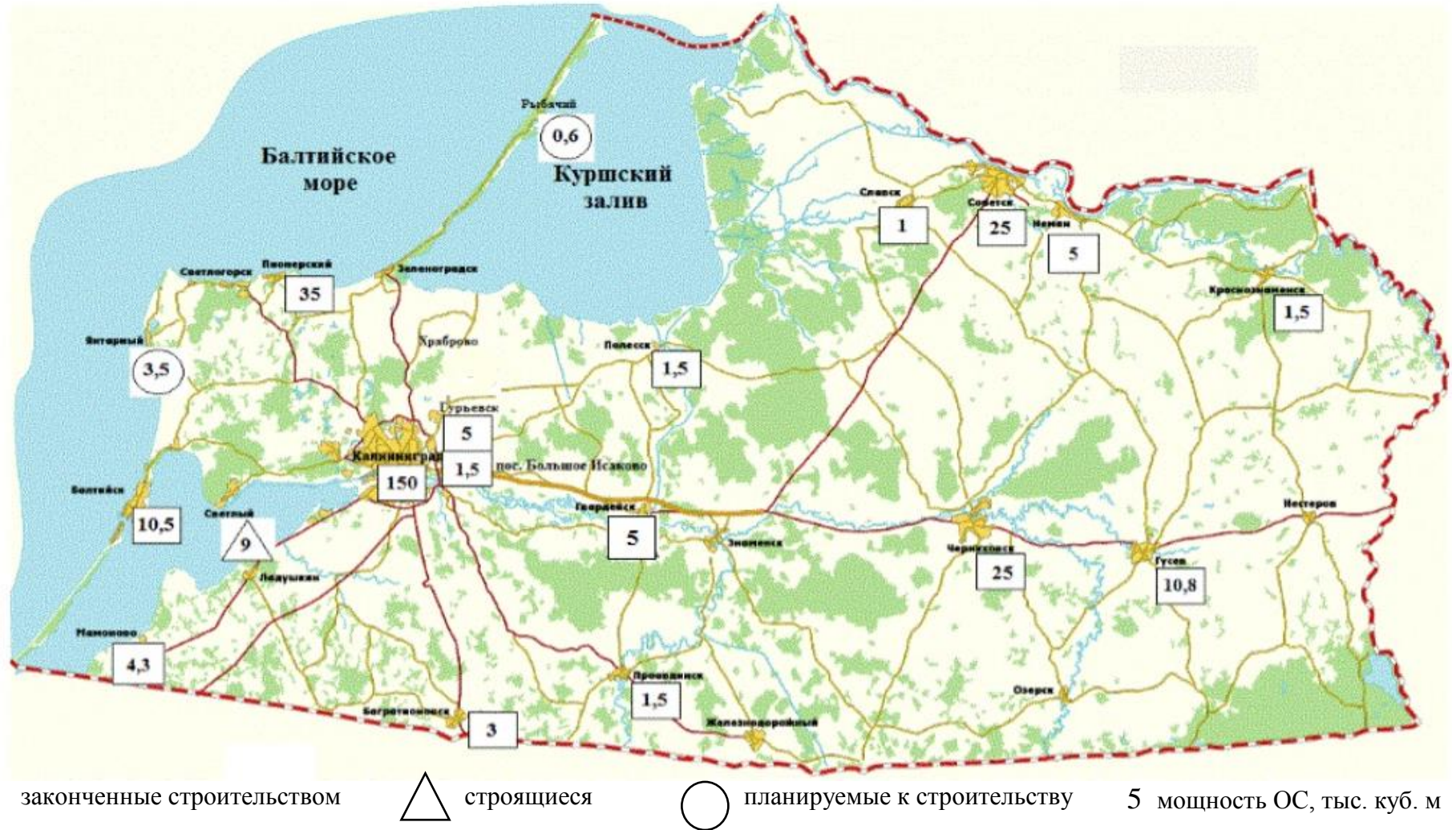
Рис. 3.18. Муниципальные очистные сооружения Калининградской области
